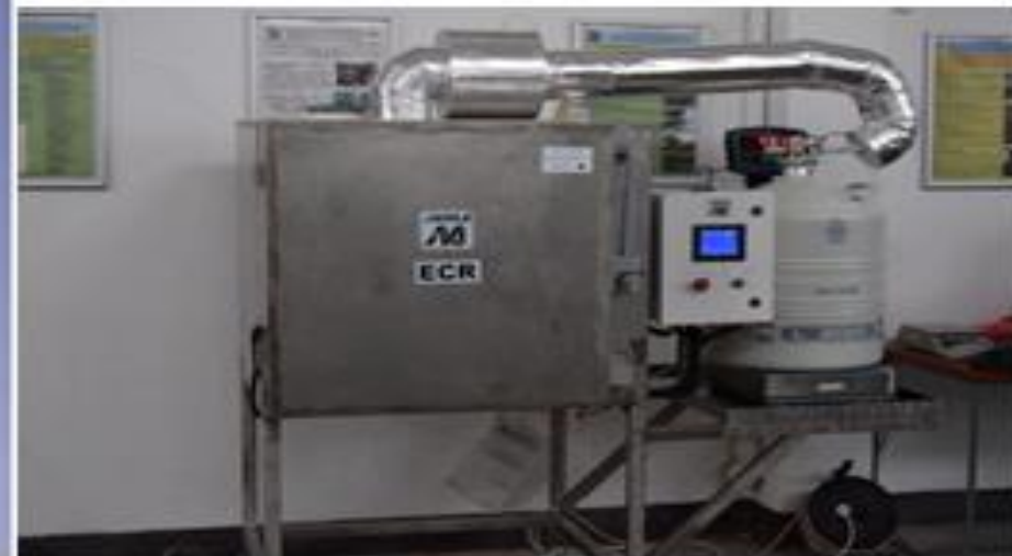
(V4) Echipament de congelare cu azot lichid cu funcționare discontinuă, ECR-0
